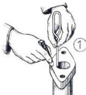
Übertragen der Lage des Luftkanals mit dem Drahhaken
