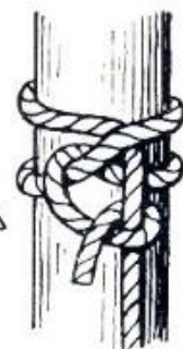
Mastwurf mit Halb- stich als Sicherung.
