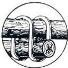
Rundgebogene Unterzug haken bei Holzkapfen
