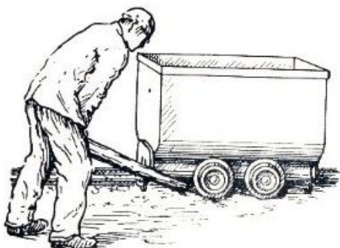
Heranrücken ans Gleis
