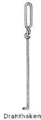
Übertragen der Lage des Luftkanals mit dem Drahhaken
