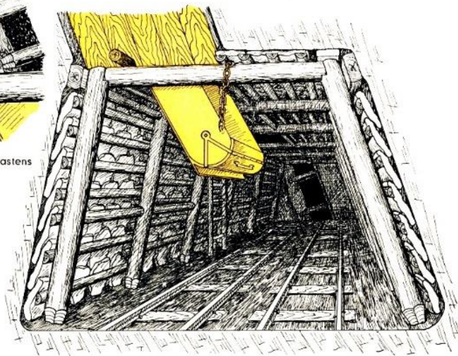
Ladekasten in steiler Lagerung
