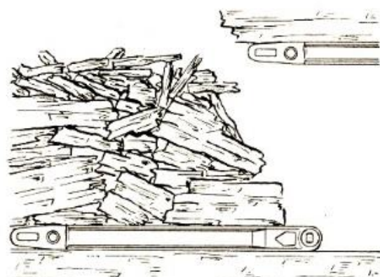
Gelenkbolzen vor dem Rauben des Stempels herausgeschlagen
