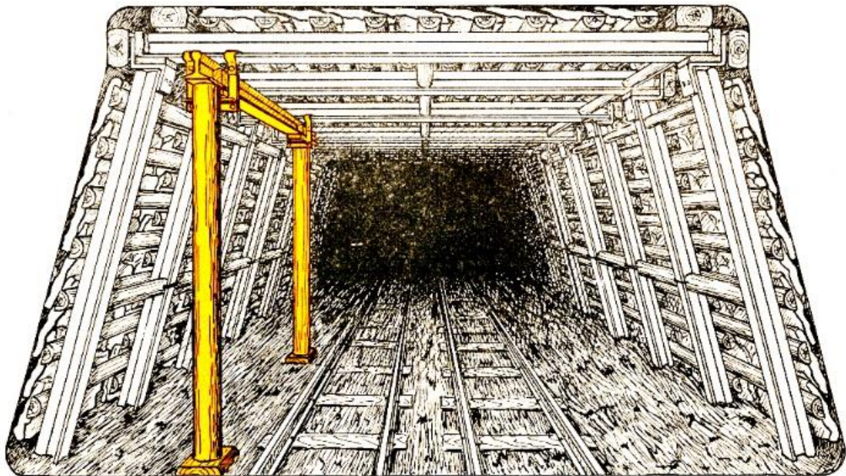
Stählerner Unterzug für das Herrichten einer Kippstelle
