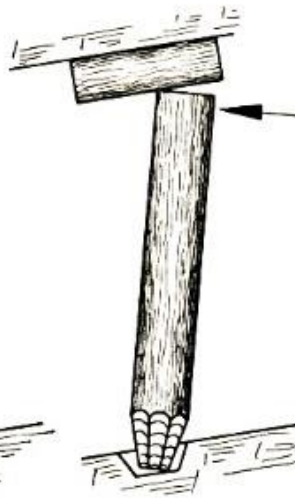
Ansetzen des Stempels unter das Kopfholz
